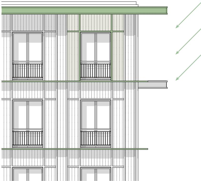
Konstruktiver Holzschutz + feines Stabwerk
